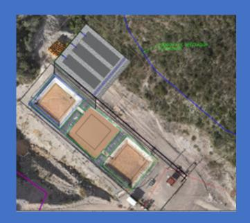
Hemos instalado tres estanques de sedimentación (bronceado) y tres geotubos (gris) para ayudar a purificar el agua.
